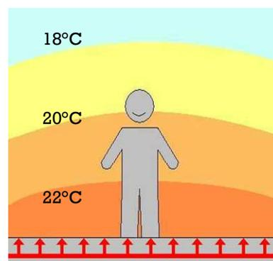
In estate si può utilizzare l'impianto radiante per mitigare l'ambiente, facendo scorrere nei tubi dell'acqua a bassa temperatura, avendo cura di regolare opportunamente l'umidità interna ai locali.
